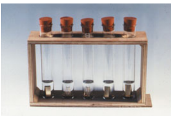
Ansatz zum statischen Immersionstest
