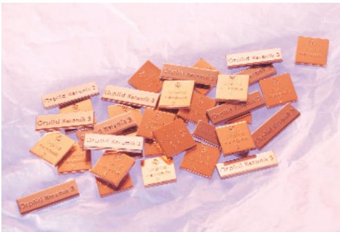
Eine Edelmetall-Legierung von C. Hafner zur Herstellung von Zahnersatz
